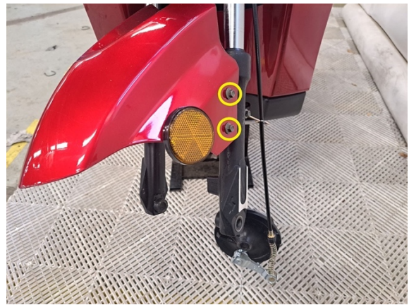
Irrota etulokasuojan kiinnityspultit kummaltakin puolelta. (hylsy 8 mm).
