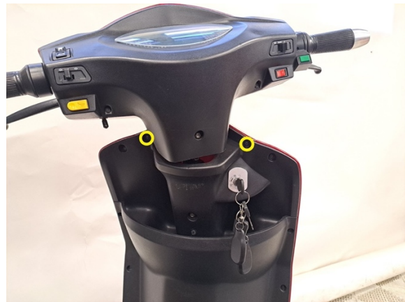
Irrota etupaneelin kiinnitysruuvit. (ristipäämeisseli ph2).
