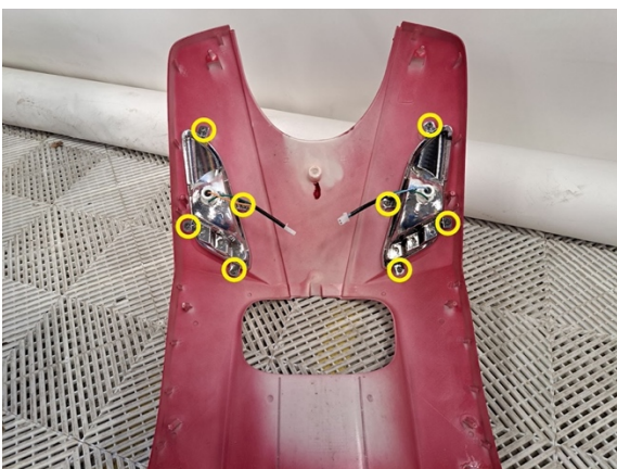
Irrota etuvilkkujen kiinnitysruuvit. (ristipäämeisseli ph2).
