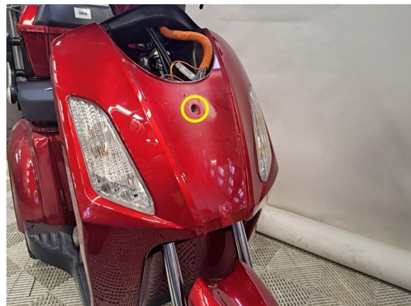
Irrota etukatteen kiinnityspultti. (hylsy 8 mm).
