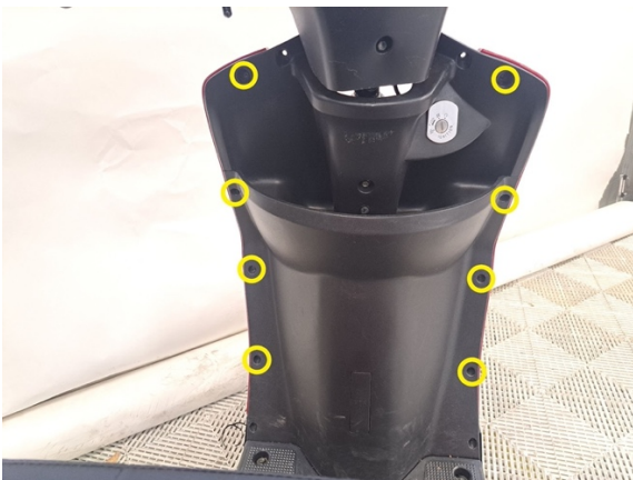
Irrota etukatteen kiinnitysruuvit. (ristipäämeisseli ph2).
